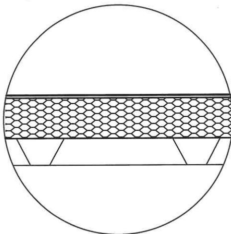
Etanchéité bitumineuse 2 couches
